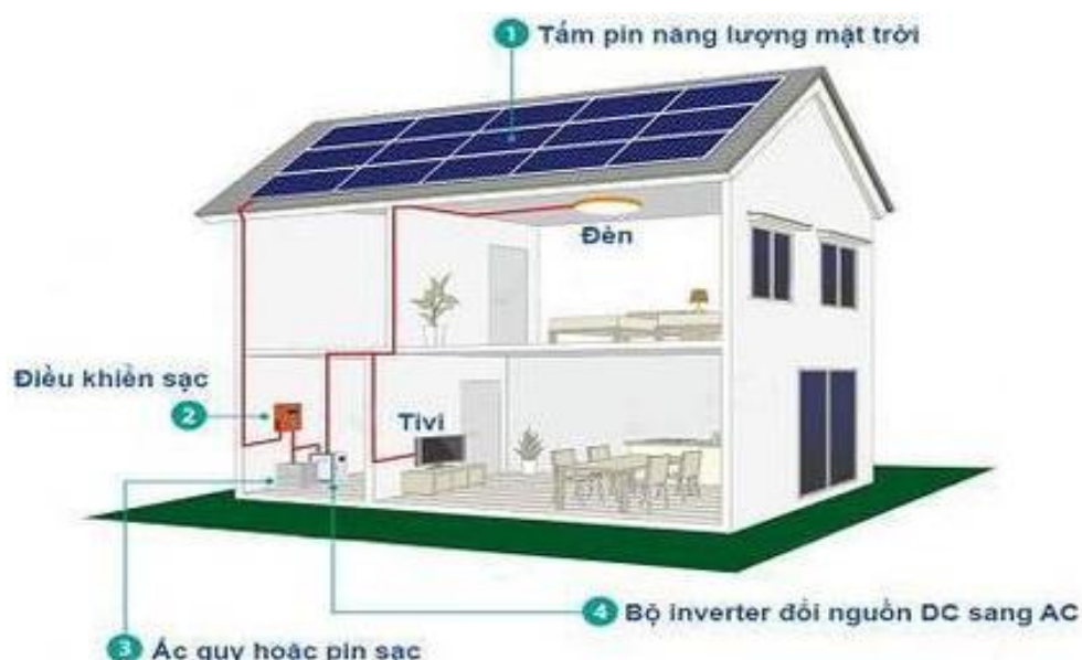
Hình 18: Lắp đặt hệ thống pin năng lượng mặt trời cho nhà ở
