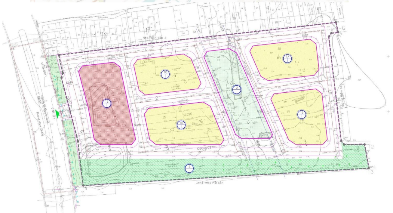
Hình 31 – Mặt bằng sử dụng đất khu tái định cư và Nhà ở xã hội, phường 12
