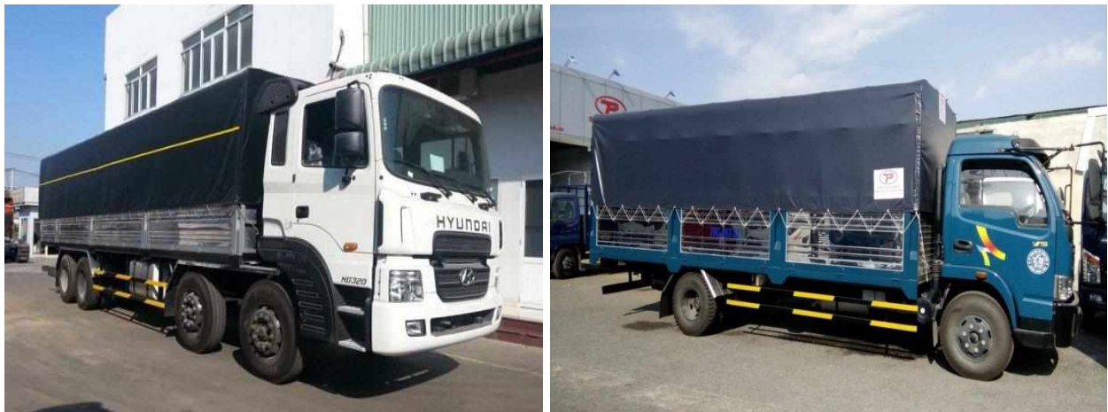
Hình minh họa xe phủ bạt che chắn khi vận chuyển nguyên vật liệu
