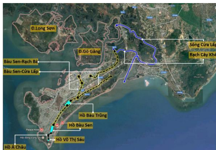
Hình 12-(Sơ đồ trục tiêu thoát nước chính tp Vũng Tàu)
