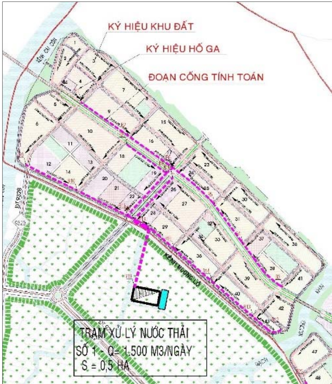
Hình 32 : sơ đồ tính toán đoạn cống thoát nước thải điển hình
